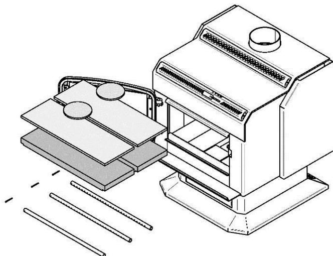
**Attention :** Le coupe-feu du poêle de gauche (représenté ci-dessous) est mal positionné. Celui de droite est parfaitement positionné. Il doit se retrouver **par-dessus les briques du fond à l'arrière**. Ne pas positionner correctement le coupe-feu, conduira à de la surchauffe et à une détérioration prématurée des composantes de la chambre à combustion, ce qui en retour, annulerait la garantie.
