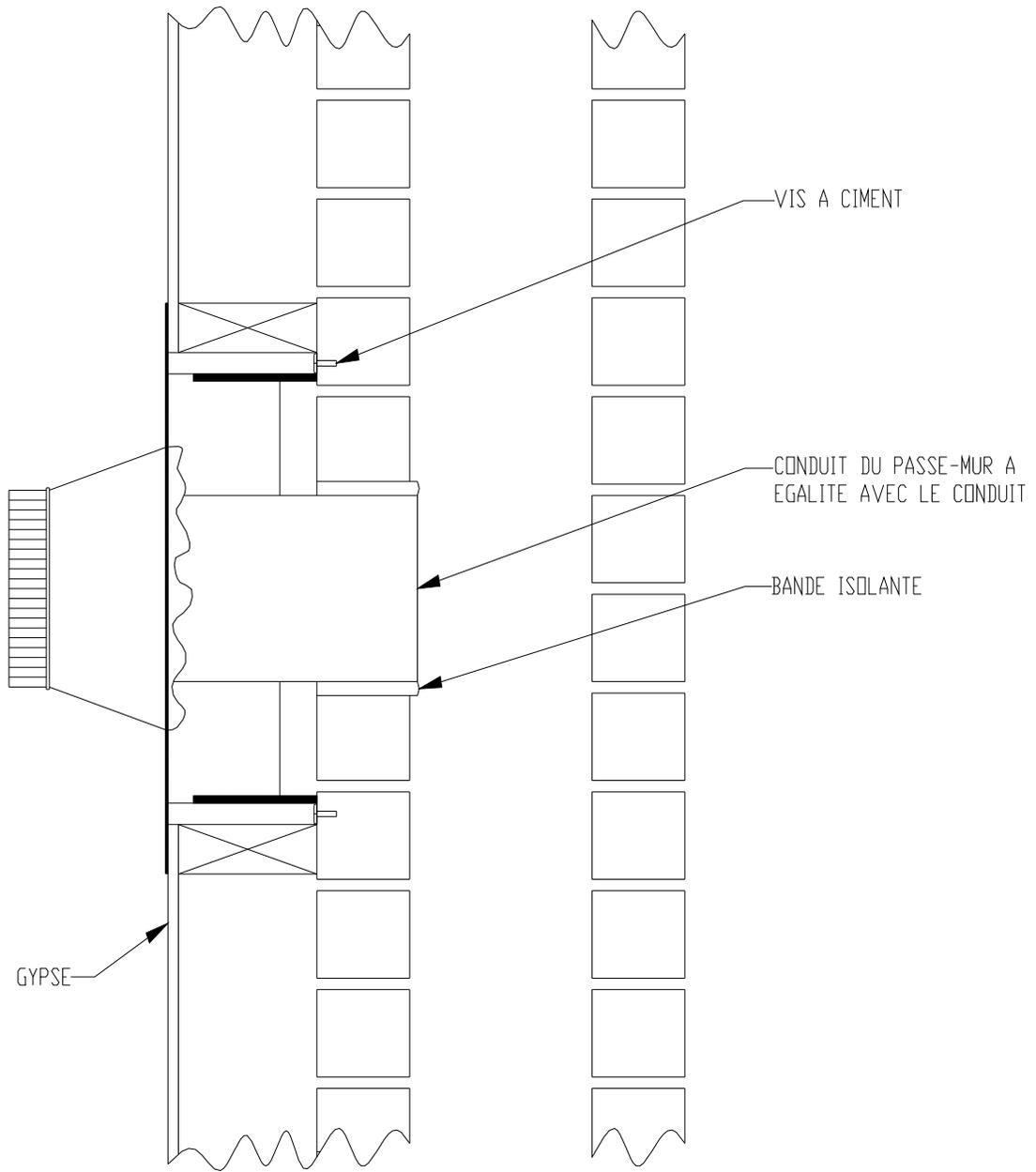
**FIGURE 2.2.2 (B) Passe-mur préfabriqué**
