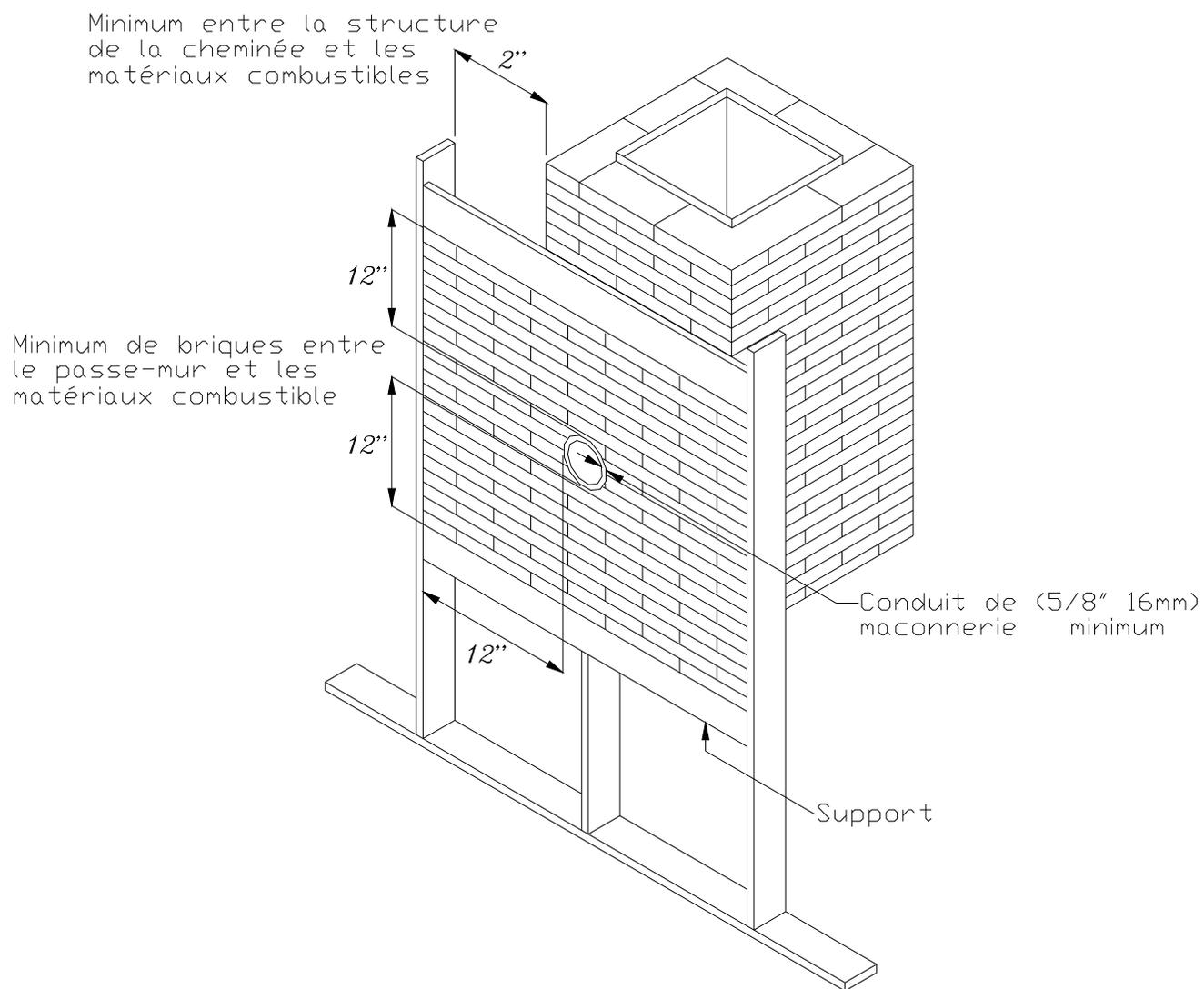
**FIGURE 2.2.2 (C) Passe-mur de briques**
