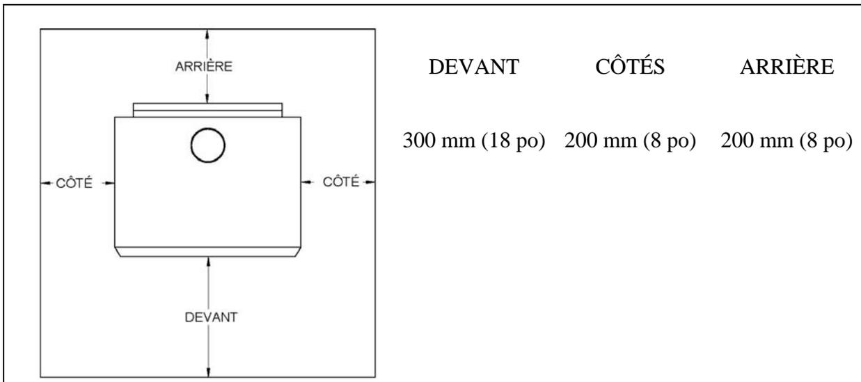
**FIGURE 1.4 Protection de plancher**
