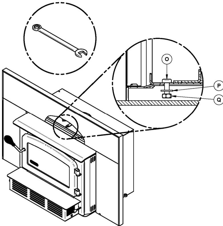
Alignez l'encoche dans l'extension de la façade avec le boulon soudé (O) à l'enveloppe de convection et faites le glisser l'assemblage au-dessus de la rondelle (P) et de l'écrou (Q). Ensuite, poussez vers la façade du foyer.
