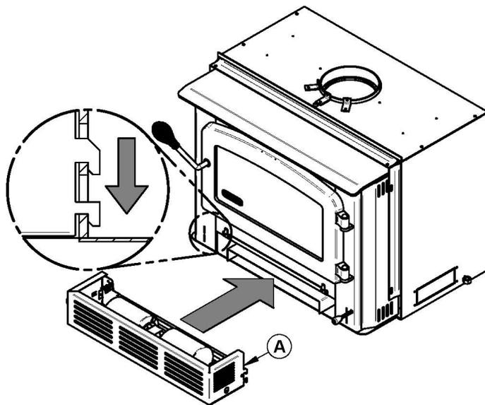
Attachez l'assemblage du ventilateur (A) à l'encastable en insérant les crochets du boîtier dans les encoches localisées à gauche et à droite de l'ouverture sous la porte de chargement.
