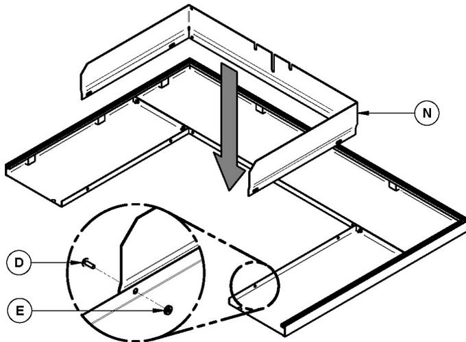
Ensuite, alignez les trous dans l'extension de la façade (N) avec les trous dans chaque panneau latéral de la façade et fixez-les en utilisant quatre (4) boulons (D) et écrous (E) fournis.
