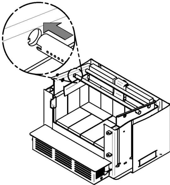
2. Alignez le chemin du tube et la dent dans le trou correspondant de la canalisation gauche.
