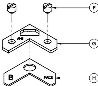
Vissez partiellement les vis (F) sur l'équerre de moulure (G) puis superposez les équerres de moulure (G) et (H) comme dans l'image de gauche.
