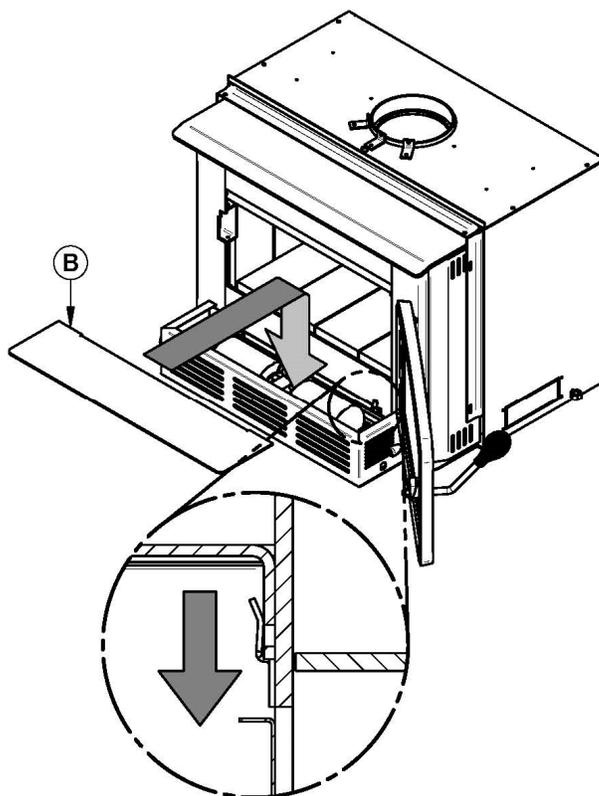
Pour assembler la tablette (B), ouvrez la porte au maximum afin de faciliter l'installation. Alignez la tablette avec le boîtier du ventilateur et appuyez-la contre la boîte à feu. Ensuite, poussez vers le bas afin d'insérer le pli arrière de la tablette dans les attaches fixées à l'encastable sous la porte de chargement.
