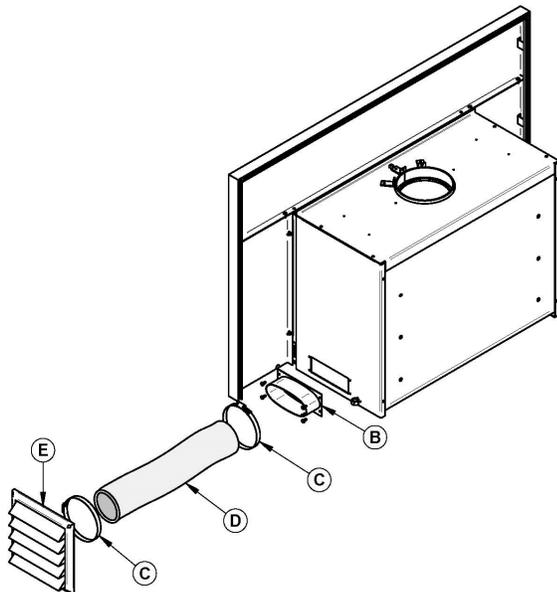
Par la suite, installez l'adaptateur d'entrée d'air (B) à l'aide de 4 vis. Fixez le tuyau flexible (D) (pièce non fournie) sur l'adaptateur (B) à l'aide d'un des collets ajustables (C). Fixez l'autre extrémité au capuchon de prise d'air (E) à l'aide du deuxième collet ajustable (C). Le capuchon de prise d'air (E) doit être installé à l'extérieur de votre habitation.
