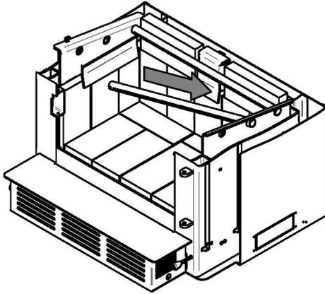
1. En commençant vers l'arrière, inclinez et insérez le tube d'air secondaire arrière dans le trou du fond de la canalisation droite.
