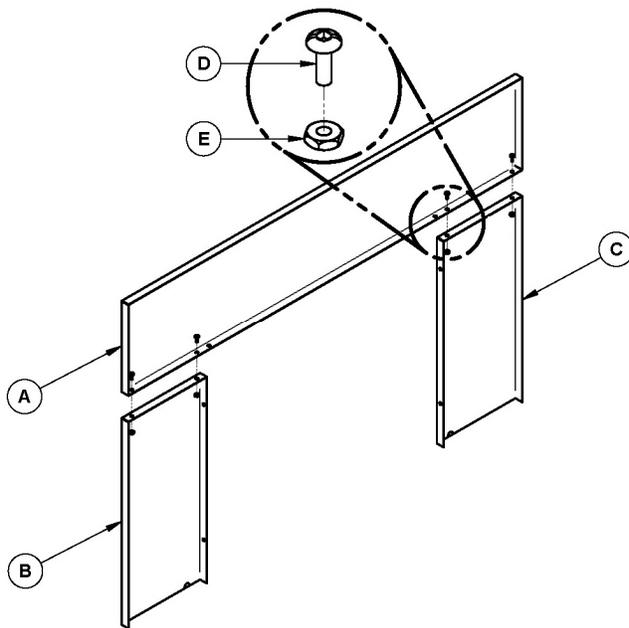
Alignez les trous du panneau supérieur (A) avec les trous des panneaux latéraux (B) et (C). Fixez-les en utilisant quatre (4) boulons (D) et écrous (E) fournis.
