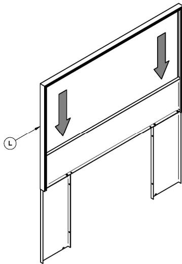
Alignez l'ensemble de moulures assemblées (L) sur le bord gauche et droit de la façade et faites-le glisser lentement vers le bas le long de la façade.
