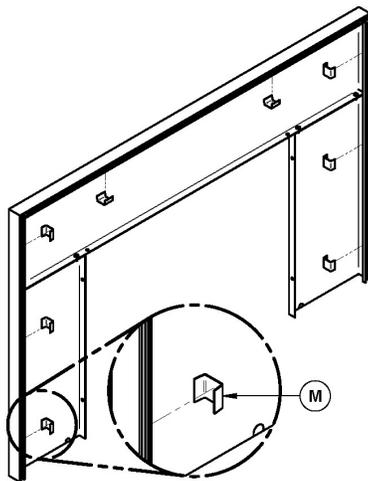
Fixez la moulure à la façade en insérant les huit attaches (M) entre le bord intérieur de la moulure et l'avant de la façade. Comme dans l'image sur la gauche.
