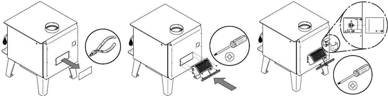
Le ventilateur est muni d'un rhéostat, voir l'illustration ci-contre pour déterminer les différentes positions d'ajustement; soit de élevé (HI) à faible (LO), ou fermé (OFF).
