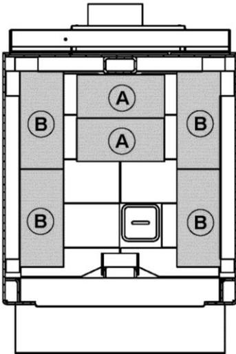
Aux fins de transport, les briques supérieures ont été mises au fond de la chambre à combustion. Il est obligatoire de les installer sur les supports de briques avant de faire fonctionner l'appareil. **Ne pas installer les briques de la façon indiquée ci-après pourrait endommager l'appareil et annulerait la garantie.**
