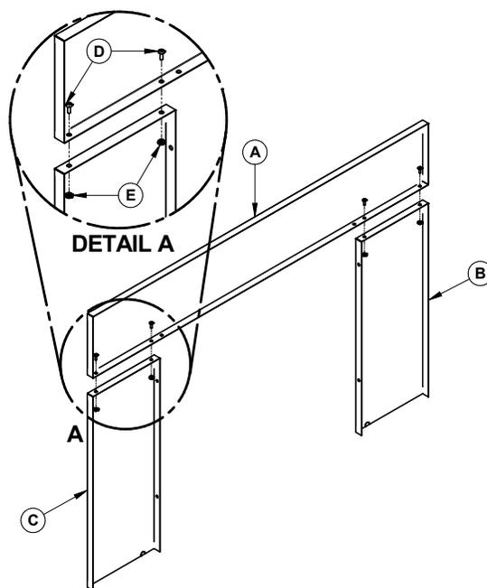
2. Déposez les panneaux avec les côtés avant des pièces sur une surface plane et non abrasive. Alignez les trous du panneau supérieur (A) avec les trous des panneaux latéraux (B) et (C). Fixez-les en utilisant les quatre boulons (D) et écrous (E) fournis.
