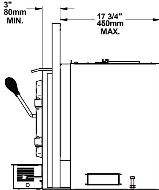
Figure 2 : Vue de côté - Projection minimum
