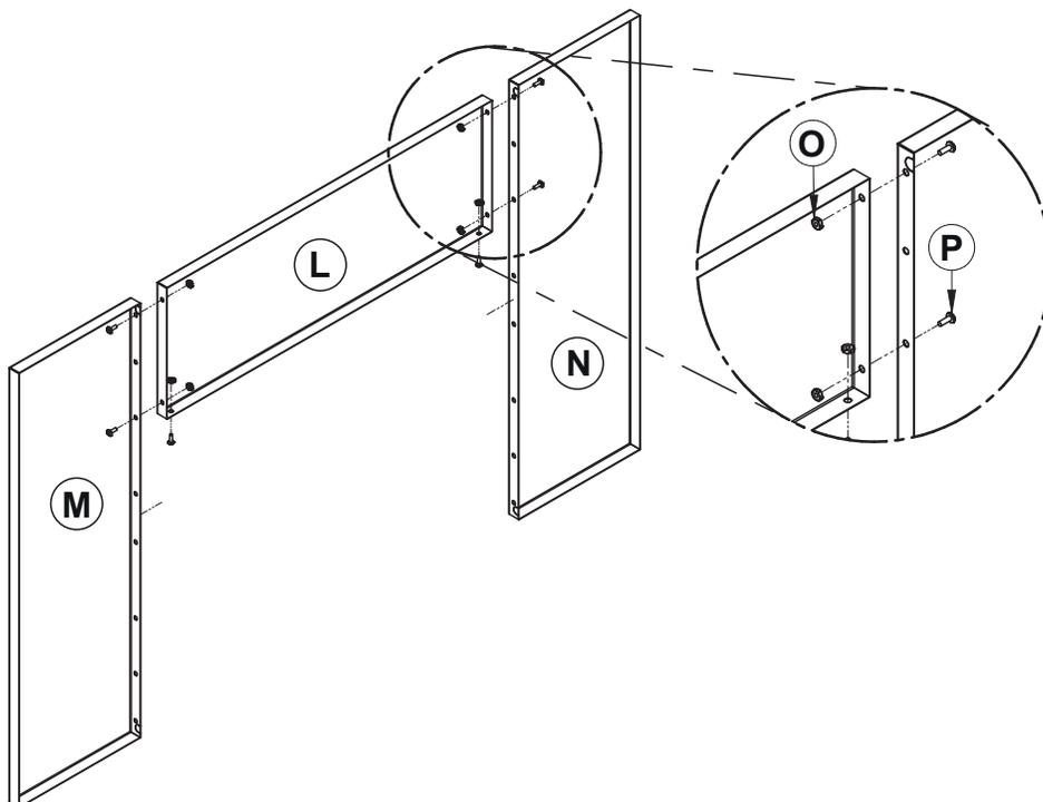
3. Ensuite, alignez les trous dans l'extension de la façade (**K**) avec les trous dans chaque panneau latéral de la façade et fixez-les en utilisant les six boulons (**P**) et écrous (**O**) fournis.
