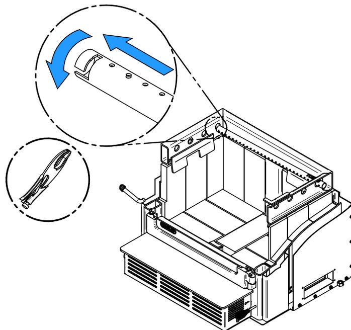
Prendre note que n'importe quel tube **(A)** peut être remplacé sans retirer le coupe-feu **(B)** et que les tubes ne sont pas nécessairement tous identiques (voir le numéro de pièce sur le tube).
