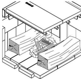
4. Ouvrez la porte et chargez : placez du papier et du bois d'allumage sur le dessus de la grille à cendres, placez les bûches nord-sud de chaque côté, puis des bûches entrecroisées par-dessus. **LAISSEZ DE L'ESPACE D'AIR ENTRE LES BÛCHES POUR UN DÉMARRAGE PROPRE ET PUISSANT!**
