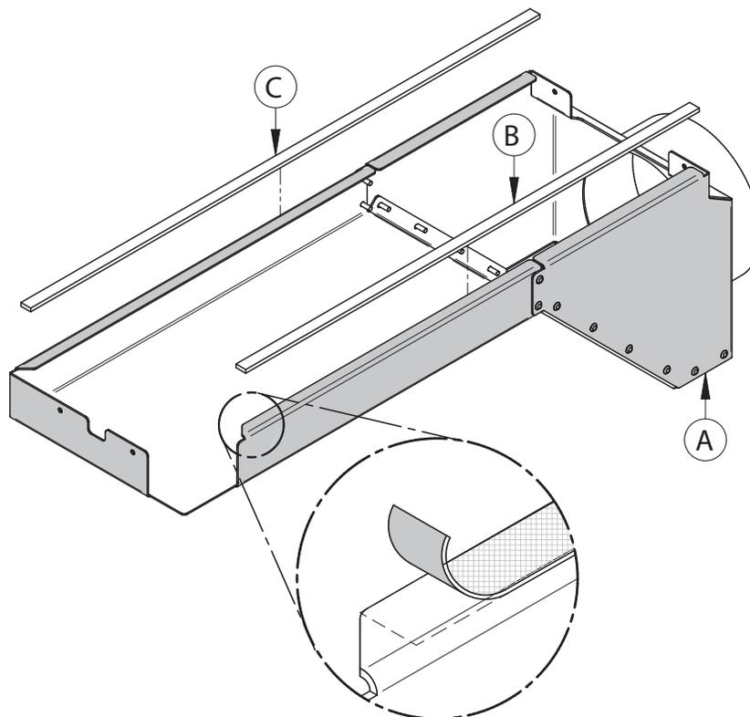
3. Positionner l'entrée d'air **(A)** sous le poêle.
