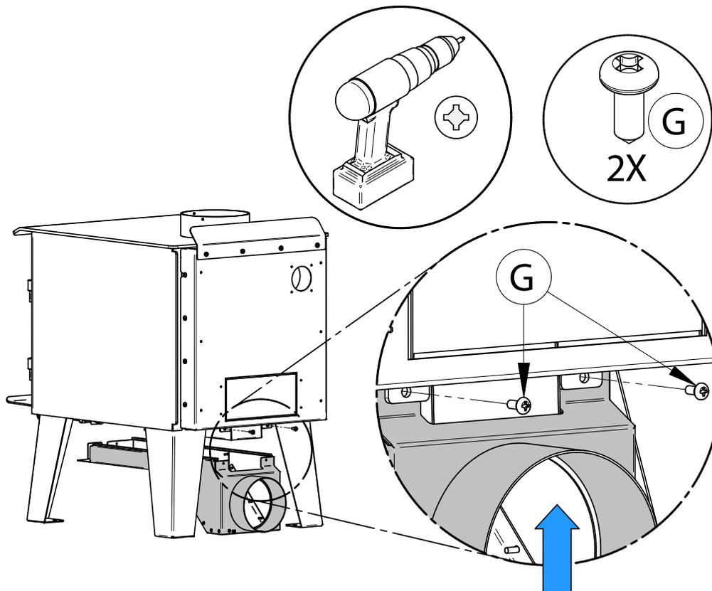
5. Fixer l'entrée d'air sur le devant du poêle avec deux vis (**G**, 2x).
