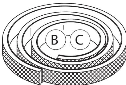
Joint d'étanchéité pré-encollé
