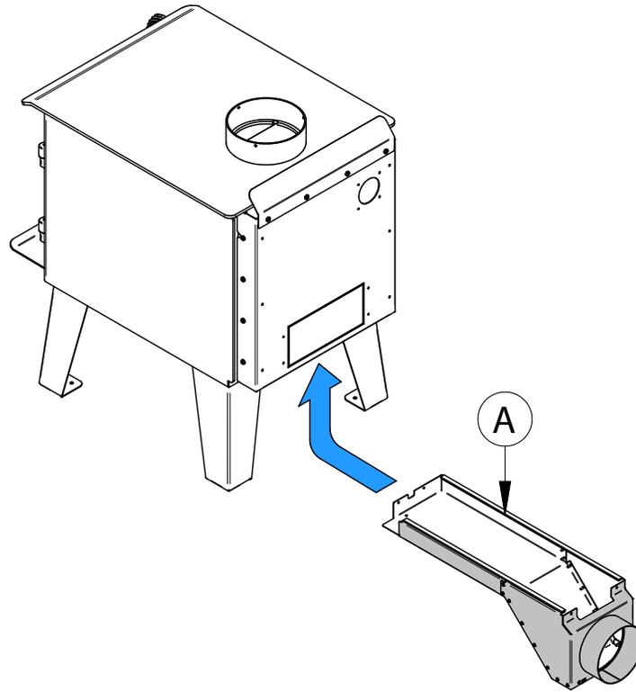
4. Fixer l'entrée d'air à l'arrière du poêle avec deux vis **(G, 2x)**.
