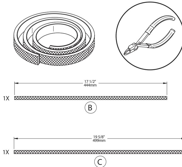
2. Installer les deux bandes de joint autoadhésif **(B et C)** sur le boîtier d'air frais **(A)**, comme montré.
