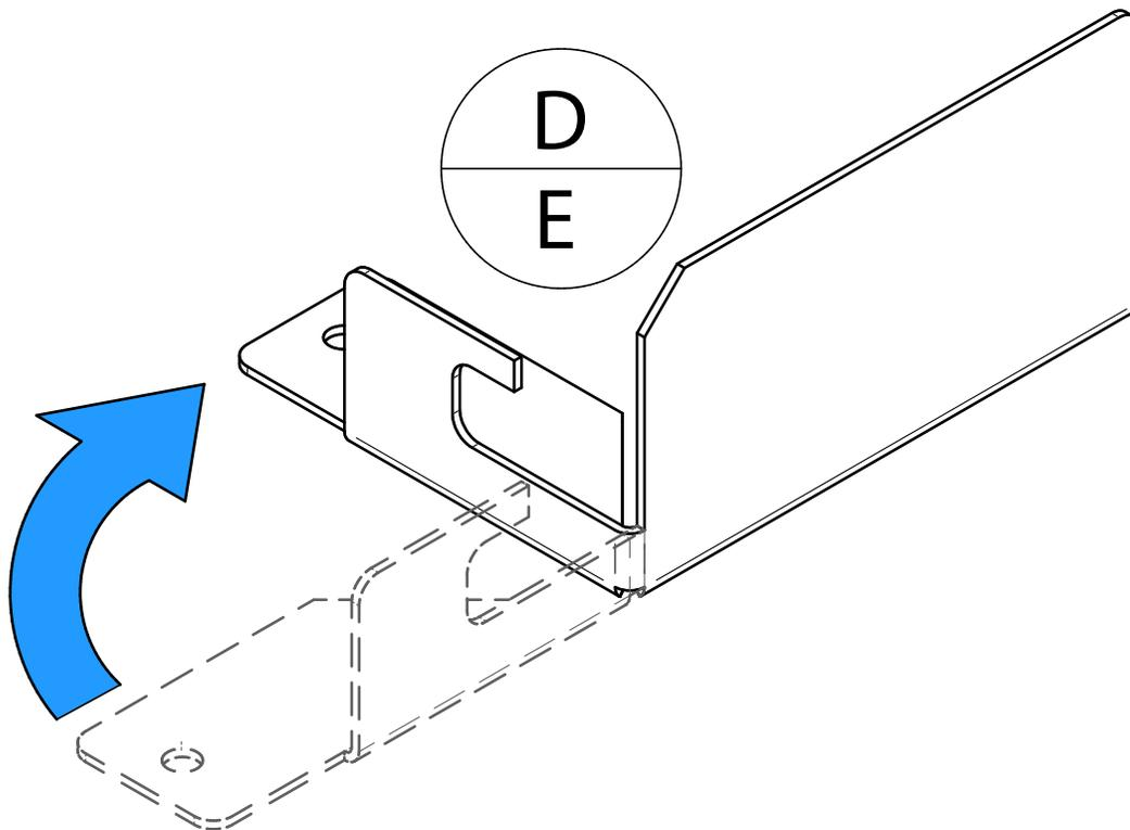
7. Fixer le couvercle du contrôle d'air (**D** ou **E**) avec deux vis (**G**, 2x). *L'exemple montre le couvercle de contrôle d'air pour une tige de trappe ronde (D).*
