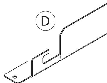
Couvercle du contrôle d'air pour une tige de trappe ronde **(D)** 1x
