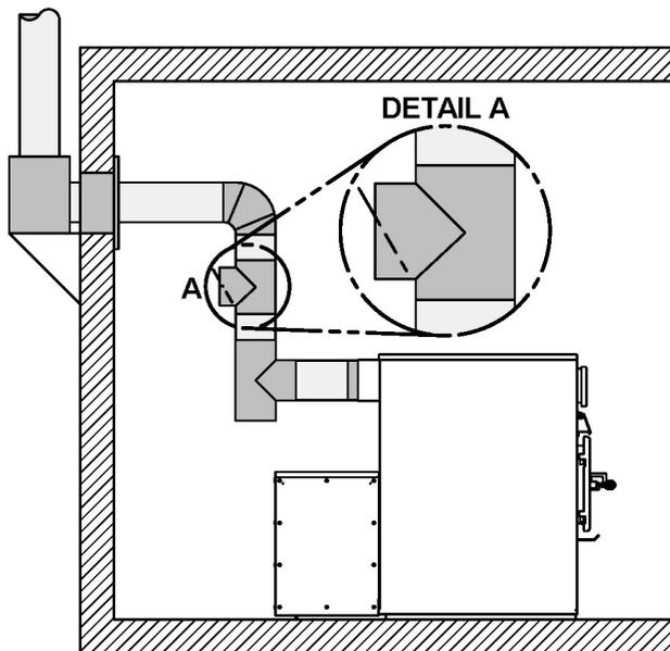
Le registre de tirage ou volet barométrique doit être ajusté de façon à limiter le tirage maximum mesuré à la sortie de la fournaise à -0,06" C.E. Veuillez noter qu'un tirage plus grand que -0,06" C.E. pourrait produire l'emballlement (feu incontrôlable) de la fournaise. **Par contre, le tirage minimum à respecter est de -0,04" C.E. dans le conduit d'évacuation.**
