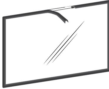
9. Remplacez la vitre (E) et le cadre de vitre (D) en la centrant dans le cadrage de la porte et installez les retiens-vitre (C) en prenant soin de ne pas trop serrer les vis (B). Notez que les deux principales causes de bris de vitre sont un positionnement inégal dans la porte et des vis de trop serrées.
