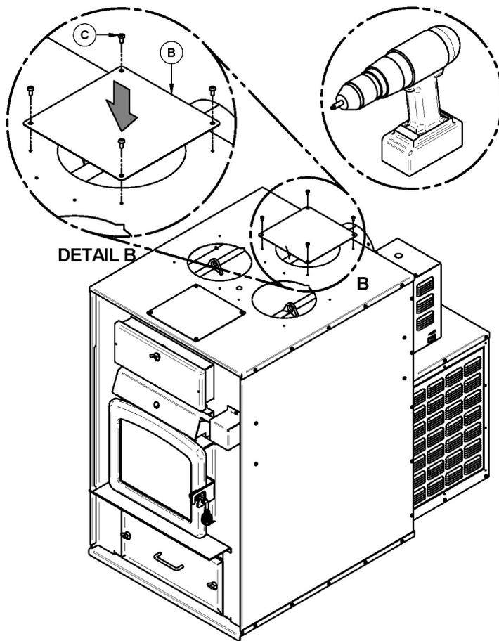
3. Ensuite à l'aide des vis fournies (C), installez les bouchons (B) sur les sorties qui ne sont pas utilisées.
