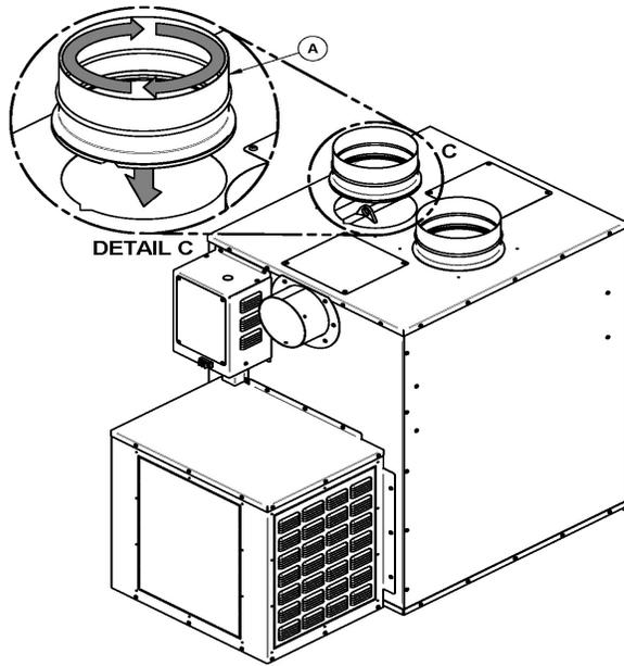
2. Alignez l'encoche de l'adaptateur (A) avec l'encoche de la sortie d'air chaud de la fournaise et tournez jusqu'à ce que la lèvre de métal soit bien insérée. L'adaptateur est bien en place lorsque sa lèvre de métal est complètement insérée et que l'adaptateur peut tourner librement. Répétez cette étape pour installer le deuxième adaptateur.
