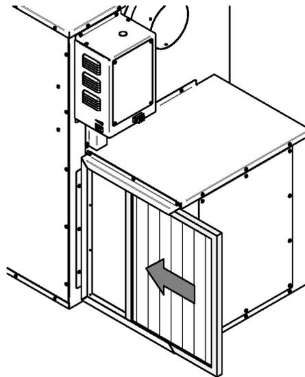
**ATTENTION: IL N'EST PAS RECOMMANDÉ D'UTILISER LA FOURNAISE SANS FILTRES. CECI S'APPLIQUE SPÉCIALEMENT AU CHAUFFAGE TEMPORAIRE EN PÉRIODE DE CONSTRUCTION. EN PLUS DE LAISSER CIRCULER LIBREMENT LA POUSSIÈRE ET AUTRE PARTICULES EN SUSPENSION DANS L'AIR, L'UTILISATION DE LA FOURNAISE SANS FILTRE PEUT ENTRAÎNER DES DÉFECTUOSITÉS DUES AUX MATIÈRES ÉTRANGÈRES DANS LES CARTERS DU SOUFFLEUR ET DES MOTEURS.**
