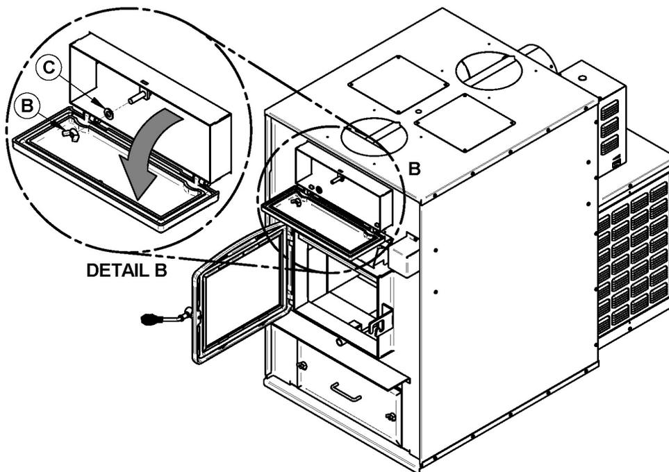
2. Déplacez le coupe-feu de la chambre à combustion vers l'avant. (Détail A)
