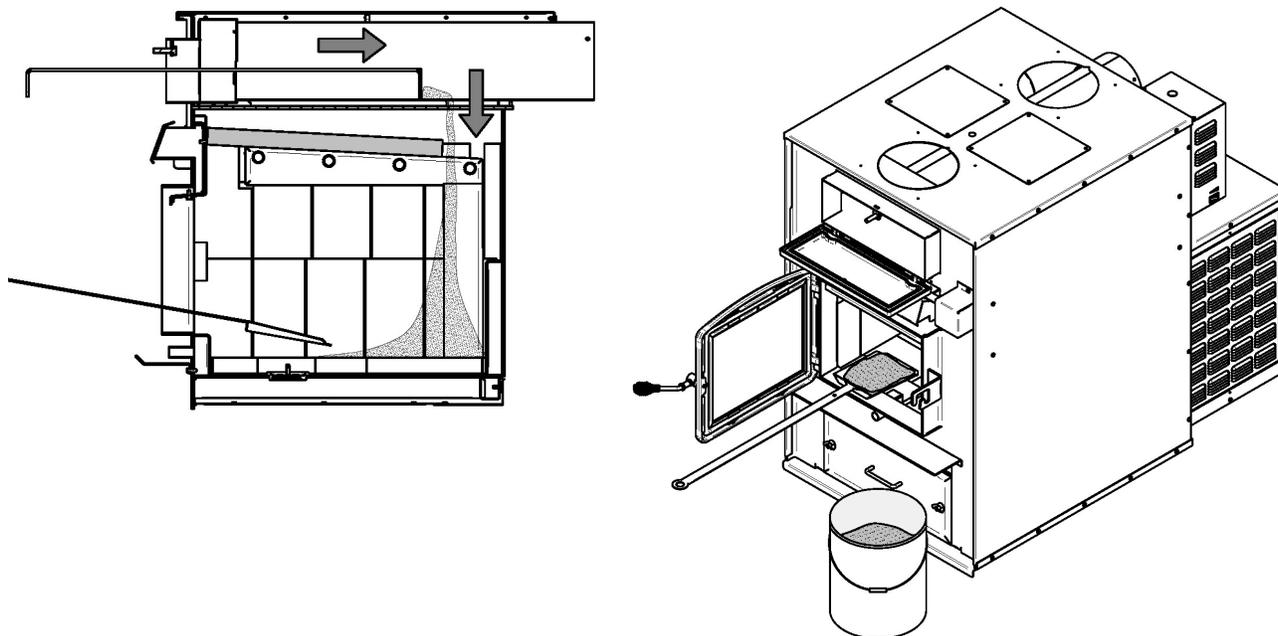
5. La saleté accumulée dans l'échangeur central (2) devra être évacuée par l'avant ou l'arrière de la fournaise. Si vous évacuez la saleté de l'échangeur central vers l'arrière de la fournaise, débranchez votre conduit de cheminée afin de disposer de la saleté.
